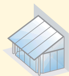
Pultdach mit Dachüberstand und 135°-Ecken
